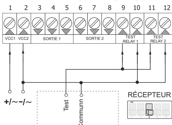
Coffret de commande avec sortie AutoTest N.O.
