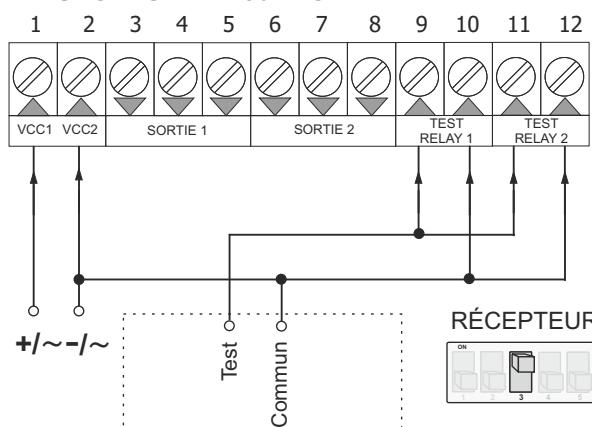
Coffret de commande avec sortie AutoTest N.F.
