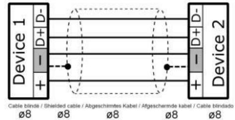
Cable blindé / Shielded cable / Abgeschirmtes Kabel / Afgeschermde kabel / Cable blindado
