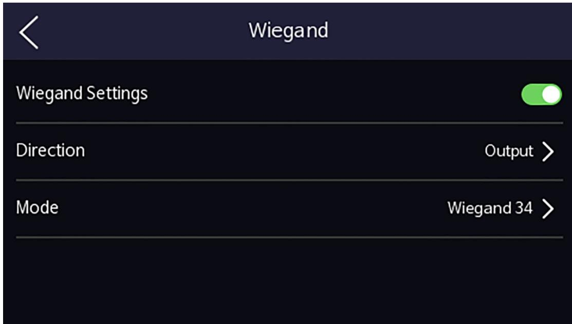
Figure 7-7 Paramètres Wiegand
